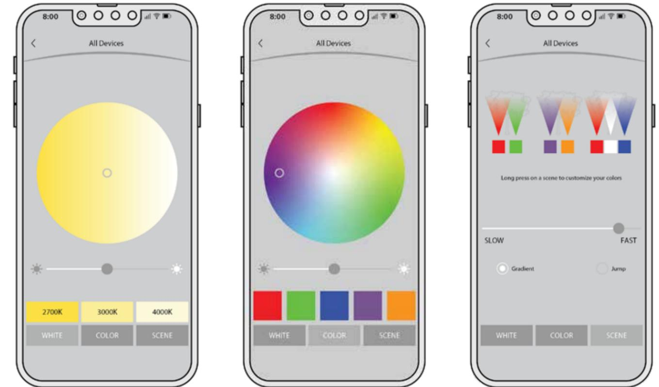
La temperatura del color se puede ajustar con botones preestablecidos. Una rueda de colores también puede utilizarse para ajustes más precisos. La atenuación se ajusta con el control deslizante.
